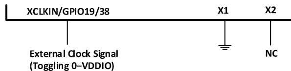
图 3-10 3.3V/5V 外部振荡器的使用
