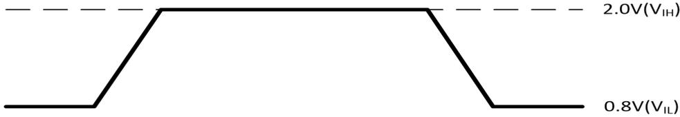
图 5-8. 输入电平
