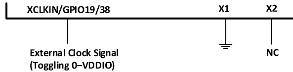
图 3-9 3.3V 外部振荡器的使用
