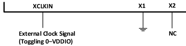
图 3-8 3.3V 外部振荡器的使用
